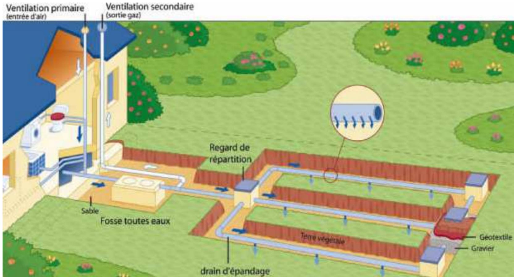
Avec cette technique, les matières polluantes sont retenues et minéralisées par la couche superficielle du sol. Des tranchées dispersent les effluents prétraités par la fosse toutes eaux. Le sol complètera leur épuration avant qu'ils ne s'infiltrent en profondeur.
