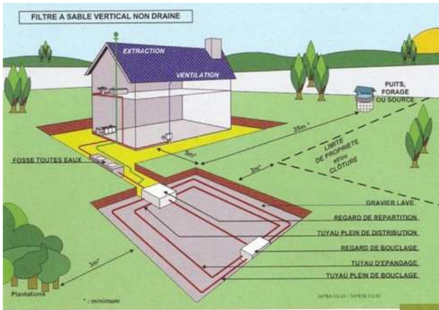
**Cette filière doit être privilégiée lorsque le sol est trop perméable, insuffisamment épais avec un sous-sol très perméable ou encore un sous-sol fissuré.**
