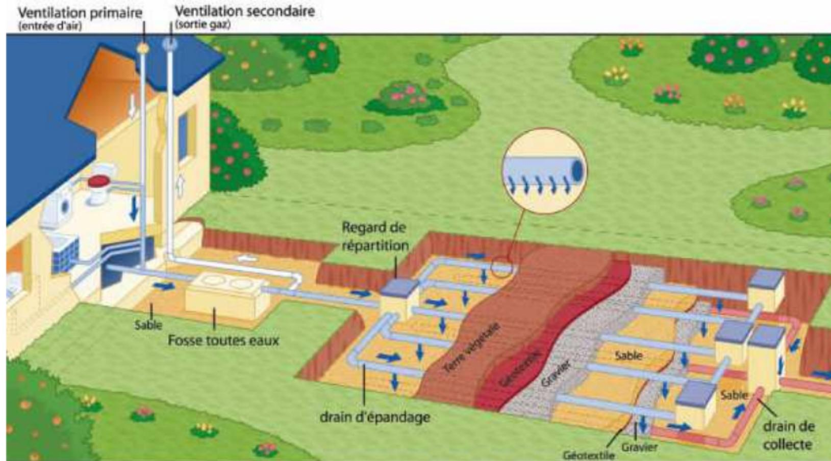
Ce dispositif est utilisé lorsque le sol n'est pas adapté pour un épandage naturel. Cette technique consiste à remplacer le sol naturel par un sol filtrant artificiel composé d'un lit de sable siliceux lavé sur une épaisseur minimale de 70 cm.
